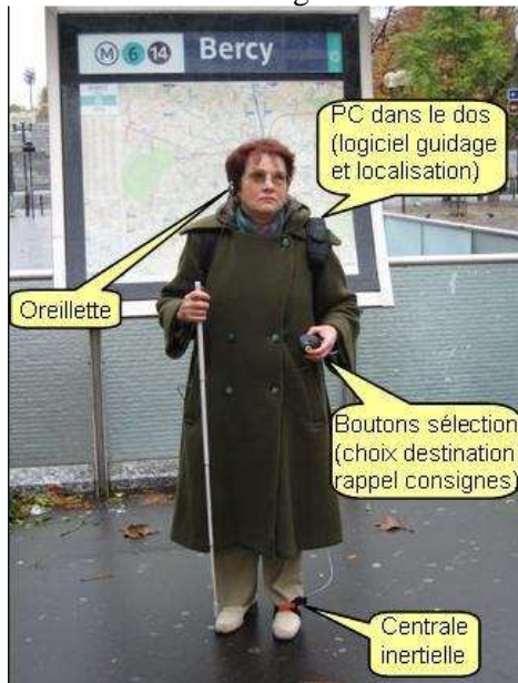
Fig.3 : Système de DANAM – essais à la station Bercy
